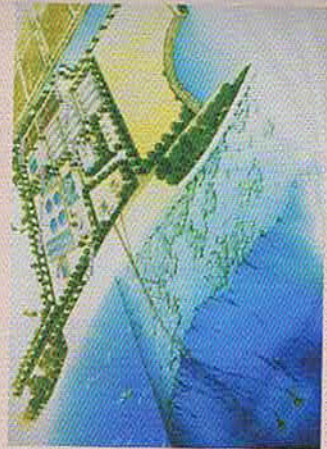
海洋深層水は沖縄海洋深層水研究所からの分水供給で、国はその取水施設、海にそばにあり、水深612mから汲み上げている。
